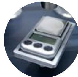
Zusätzliche Waage zur Probeneinwaage
