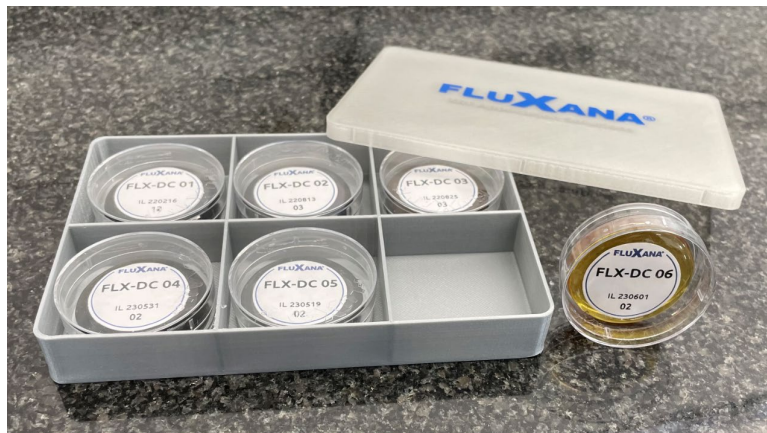
Abb. 3 Universal-Driftmonitor-Set FLX-DC, bestehend aus 6 Proben FLX-DC 01 bis FLX-DC 06.
